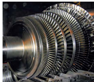
Turbine en acier inox au molybdène pour centrale thermique (© www.imoa.info)
